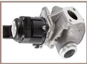
La válvula **EGR** permite controlar la cantidad de gas reciclado del tubo de escape. Después, el motor de control se alimenta mediante el calculador del inyector y la válvula EGR abre el sistema de recirculación de gas del tubo de escape. Esta apertura es progresiva y se define mediante el motor de control basado en EGR. La válvula EGR incluye un sensor de Hall para la válvula servo accionado.
