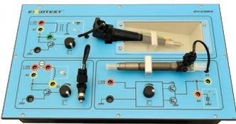
**Module Actionneur - Injection et allumage - Réf. DT-C002**
