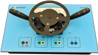
**Module Capteur - Angle volant - Réf. DT-M001**
