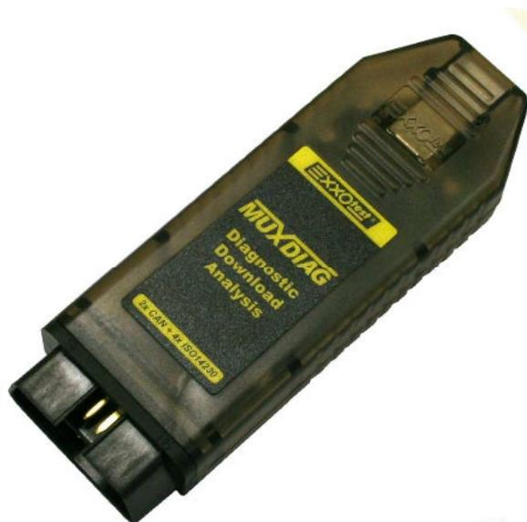
La prise USB-MUX-DIAG permet d'interfacer un ordinateur de type PC (ou Pocket PC) aux lignes de diagnostic CAN et KWP2000 du véhicule par l'intermédiaire de la liaison USB. La prise dispose des liaisons suivantes :
