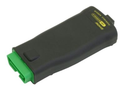
La prise USB-MUXDIAGII permet d'interfacer un ordinateur de type PC (ou Pocket PC) aux lignes de diagnostic CAN et KWP2000 du véhicule par l'intermédiaire de la liaison USB. La prise dispose des liaisons suivantes :
