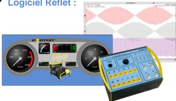
Le logiciel **REFLET**, relié en USB à son boîtier d'acquisition, permet de réaliser des écrans de mesure entièrement personnalisés. Idéal pour l'étude des signaux de votre moteur : oscilloscope 4 traces, 12 entrées analogiques, calculs de fréquences, de rapport cyclique, de températures, compte-tours ... Analyse des courbes relevées, enregistrements, impression ...
