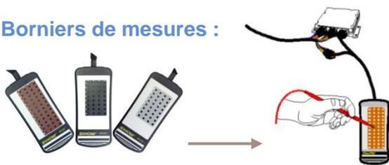
Avec l'ensemble **BM-PACK-ED**, vous aurez accès à l'ensemble des 112 voies du calculateur (48V MR, 32V NR, 32V GR) pour la mesure (sans possibilités de pannes).
