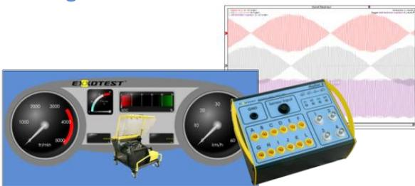
Le logiciel **REFLET**, relié en USB à son boîtier d'acquisition, permet de réaliser des écrans de mesure entièrement personnalisés. Idéal pour l'étude des signaux de votre moteur : oscilloscope 4 traces, 12 entrées analogiques, calculs de fréquences, de rapport cyclique, de températures, compte-tours ... Analyse des courbes relevées, enregistrements, impression ...
