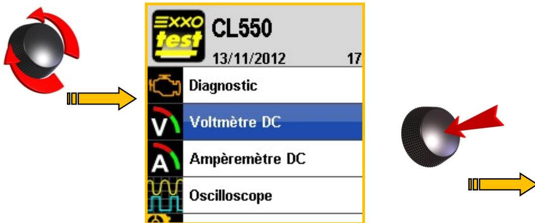
Utiliser le fil rouge pour la mesure d'une seule tension par rapport à la masse batterie (1 voie) ou le fil rouge et le fil noir pour la mesure de deux tensions distinctes par rapport à la masse batterie (2 voies).
