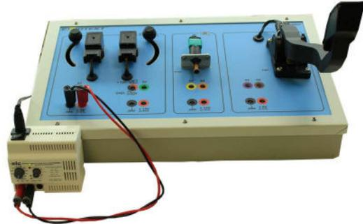
**Remarque :** un dispositif de protection avec buzzer vous informe si la tension d'alimentation est supérieure à 12 v ou 5 v suivant montage, ou si le plus et moins sont inversés.
