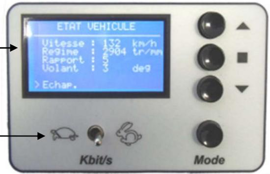
Sélecteur du débit des bus. Il peut être configuré en mode réel ou en mode ralenti s'adaptant ainsi à tous les oscilloscopes possédant une bande passante supérieure à 10 MHz.
