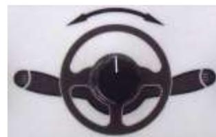
Il fournit au calculateur ESP les informations relatives à l'angle de braquage des roues avant ainsi que le sens de braquage (volonté conducteur).
