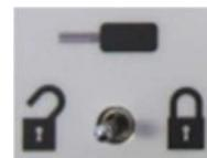
S'il y a une action sur le poussoir impulsionnel alors que le véhicule est au-delà des 10 km/h, les portes de déverrouillent.
