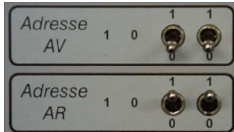
Réglage sur le module MUX8004 AR.
