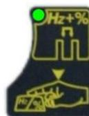
Le **GI3000** mesure un rapport cyclique compris entre 1 et 99 %. Si la mesure est en dehors de ces limites, l'afficheur clignote sur la dernière valeur.
