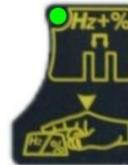
Le voyant **%** sous l'afficheur s'allume. L'afficheur indique la valeur de départ de 5%, le rapport cyclique est réglable jusqu'à 95%. Le réglage s'effectue à l'aide de la molette (une rotation vers la gauche diminue la valeur, une rotation vers la droite l'augmente). La valeur en % indique le temps de commande à l'état bas (commande par la masse).
