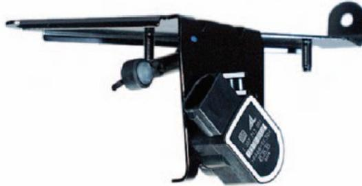
Los sensores angulares están fijados a un elemento de la carrocería del vehículo y están ligados a los brazos de la suspensión delante y detrás de la barra anti-peralte a través de un sistema de bielas. Sirven para medir la inclinación del vehículo, su rango es de +/- 45 grados.
