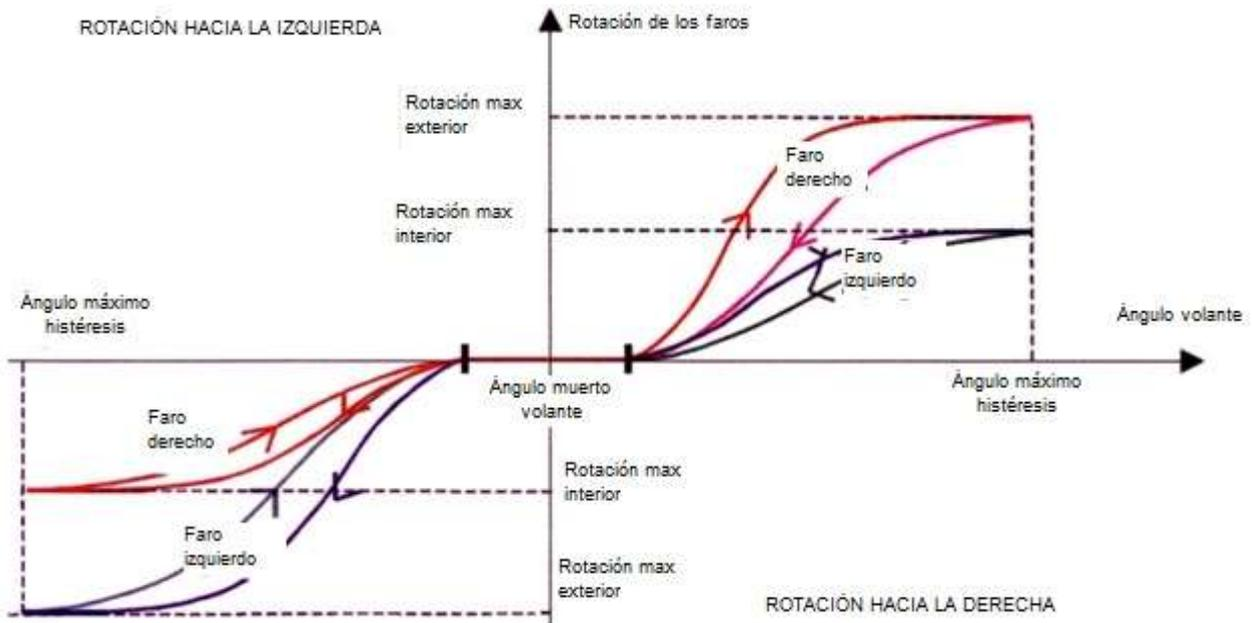
**Ejemplo: para un giro a la derecha con una rotación del volante inferior a  $80^\circ$  : mismo principio que para un giro a la izquierda.**
