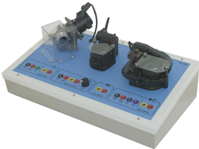
Le module **DT-C003** est un support pédagogique pour l'étude et la compréhension des actionneurs en PWM sur des éléments automobile réels.
