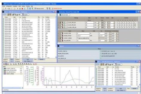
**MUXTRACE Expert :** Analyseur / émulateur – réseaux CAN, CAN FT, LIN, KWP, VAN & J1708.
