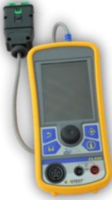
Opcionalmente, puede utilizar con este modelo didáctico nuestra herramienta de análisis EOBD para leer parámetros. El probador multifunciones **EXXOTEST® CL550** reúne las funciones de osciloscopio, multímetro y herramienta de análisis OBD II.
