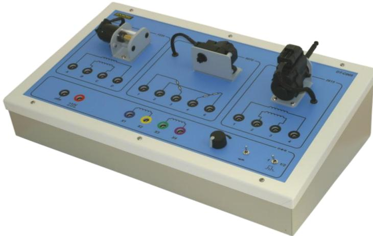
Le module **DT-C005** est un support pédagogique pour l'étude et la compréhension des moteurs pas à pas, il utilise des **éléments automobile réels**.
