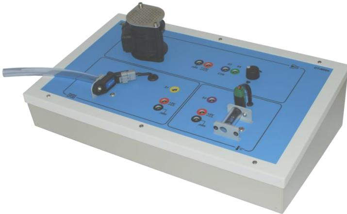
Le support pédagogique DT-M004 est équipé d'éléments automobiles réels. Il permet l'étude et la compréhension des capteurs servant à caractériser l'air d'admission des moteurs. Ces informations sont primordiales pour le calcul de la quantité de carburant à injecter.
