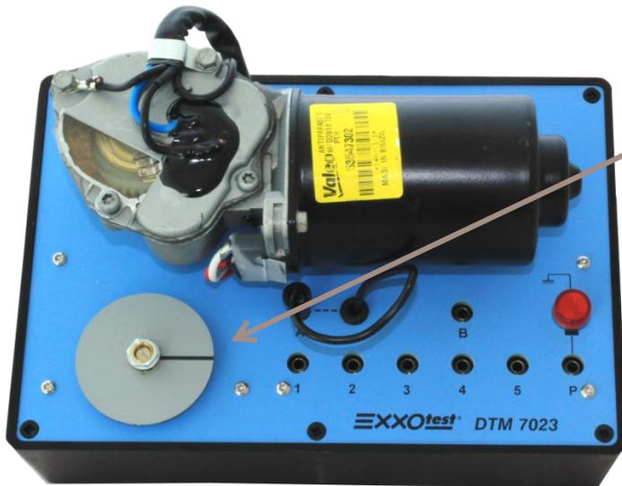
Ventana en la unidad de engranajes reductores del motor donde se muestra el sistema automático de posición de retorno del brazo y el sistema de estacionamiento.
