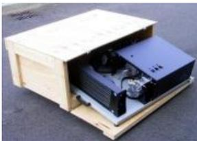
**Herramienta de diagnóstico EXXOCLIM:** La herramienta autoalimentada de diagnóstico del aire acondicionado para automoción R134, **EXXOCLIM** permite realizar mediciones, monitorizar y obtener diagnósticos automáticos de todo el bucle frío del sistema, de un componente o de la funcionalidad.
