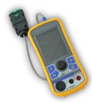
El simulador didáctico MT-E5000 incluye una herramienta de análisis EOBD para leer parámetros y los códigos de avería. ΕI probador multifunciones EXXDTEST® CL550 reúne las funciones de osciloscopio, multímetro y herramienta de análisis OBD II.
