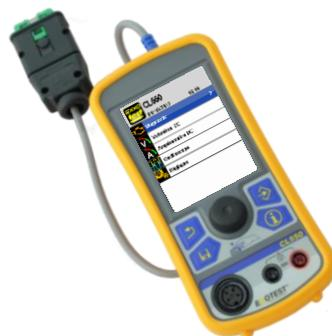
Probador multifunciones **EXXOTEST® CL550**, que reúne las funciones de osciloscopio, multímetro y herramienta de análisis OBD II.
