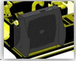
El sistema de refrigeración, situado en la parte delantera del chasis, incluye el radiador, la unidad de ventiladores, varias mangueras y una botella de expansión.
