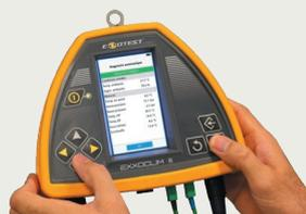
**En option, EXXOCLIM3 + Kit HFO1234yf :** Outil d'aide au diagnostic des circuits de climatisation au HFC-R134a et HFO-134yf permettant la mesure et l'interprétation des pressions (HP et BP), température et hygrométrie d'air ambiant, température d'air pulsé, température du réfrigérant (4 points de mesure). Fonctions traceur, enregistrements, éditions de rapports de diagnostic, etc
