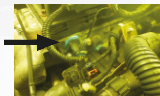
Il suffit de jeter un œil à travers les lunettes UV : le traceur contenu dans la fumée rend clairement visible les points de fuite
