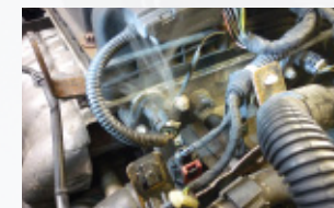
La fumée qui s'échappe permet de localiser la zone de fuite
