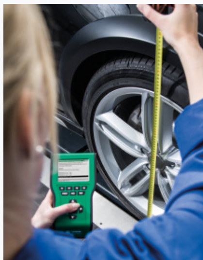
Mesurer la hauteur des différentes roues
