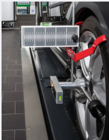
Positionner le CSC-Tool parallèlement au véhicule et en le centrant
