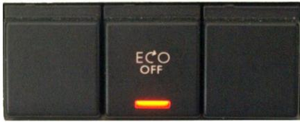
L'appui sur ce bouton empêche l'arrêt du moteur thermique.
