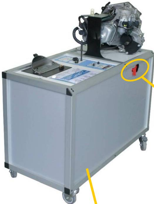
L'intérieur de la maquette n'est accessible qu'après dépose de la plaque de protection.
