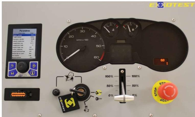
Prise de diagnostic 16 voies pour le branchement d'un outil de diagnostic.
