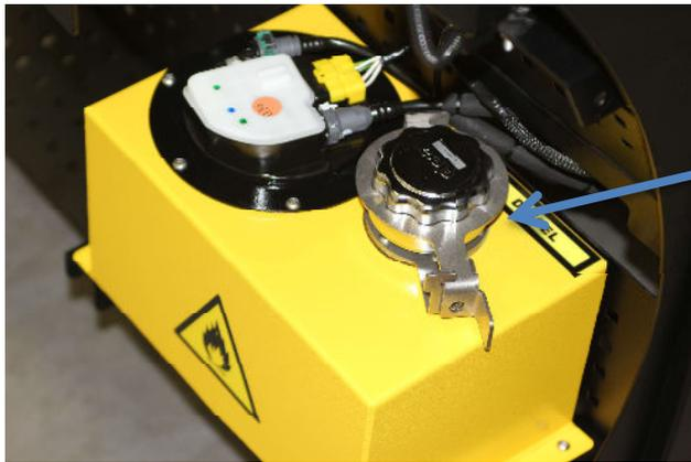
Présence d'un système de condamnation du bouchon de réservoir pour éviter toute action malintentionnée.
