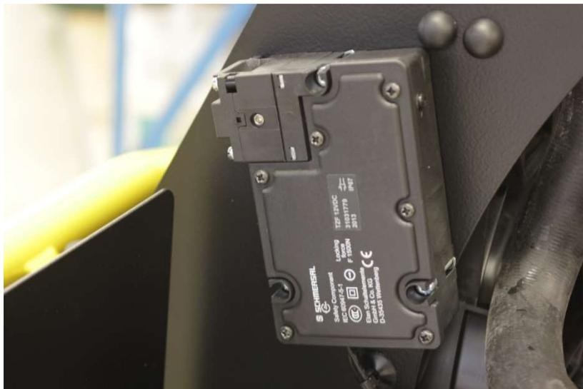
Serrure de porte sécurisée, système électrique d'ouverture, fermeture manuelle.
