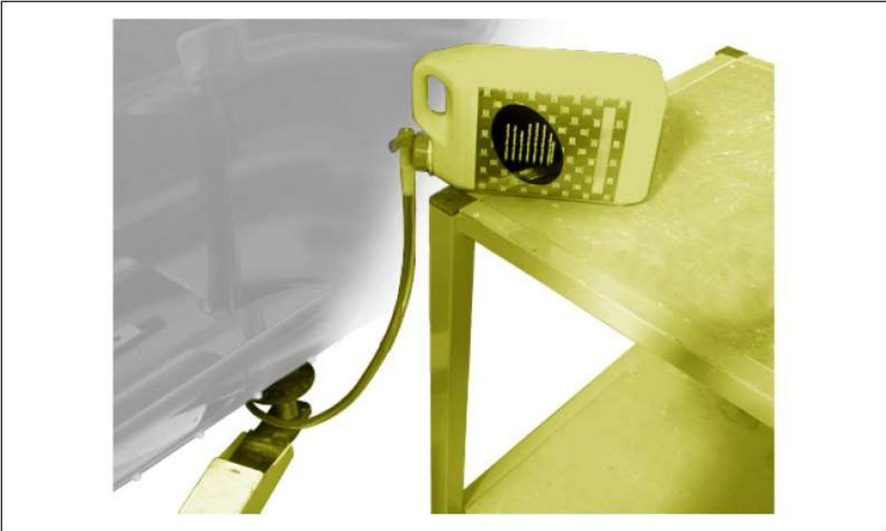
Placer le bidon d'additif à un niveau supérieur à celui du réservoir d'additif.
