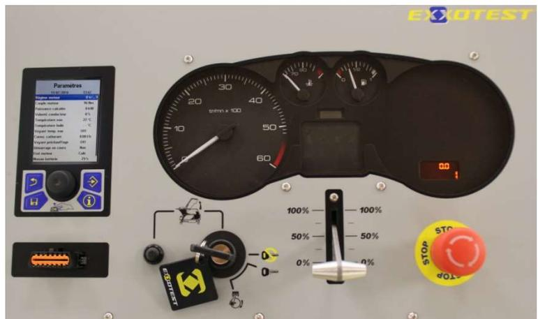
Ecran haute résolution pour l'affichage des informations moteur du réseau CAN et des capteurs optionnels...
