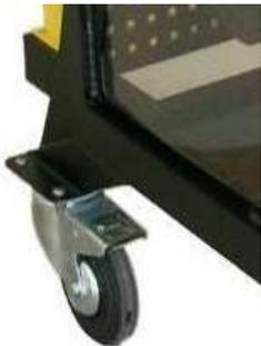
Il n'y en a qu'un situé sur la roue arrière droite, il doit être actionné lors du stockage ou de l'utilisation du support moteur.
