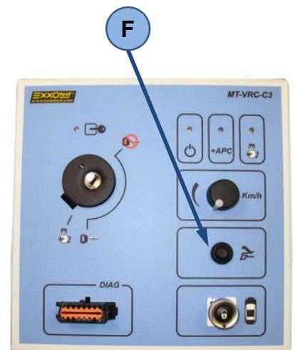
Lors de l'appui sur le contacteur d'ouverture du coffre (repère **F**), le moteur électrique est alimenté. Il entraîne le pignon de transfert en rotation, qui lui fait tourner une vis sans fin à l'intérieur de l'axe de transfert en translation. Cet axe étant bloqué en rotation, il se déplace en direction du moteur et tire le levier de désengagement de la gâche, il libère le coffre.
