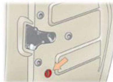
Elle interdit l'ouverture, de l'intérieur, de chacune des portes arrière.
