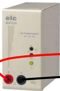
Utiliser l'alimentation fournie 12V, 10A (référence **eic** : ALF1210). Lire la notice d'utilisation et déclaration de conformité du fabricant, pages suivantes. Vérifier la position de l'interrupteur sur l'arrière de l'alimentation (placer sur **0**) puis brancher l'alimentation au secteur 230V.
