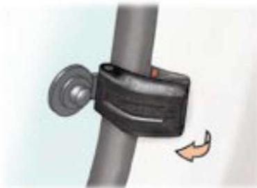
Pour entrebâiller les vitres arrière, basculez le levier, puis poussez-le à fond pour verrouiller les vitres en position ouverte.
