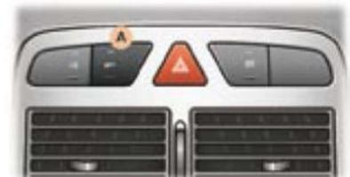
L'appui sur le bouton **A** vous permet de verrouiller ou déverrouiller le véhicule.
