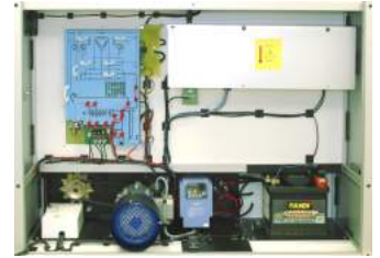
Vista trasera : batería y cargador, motor eléctrico y variador de velocidad.
